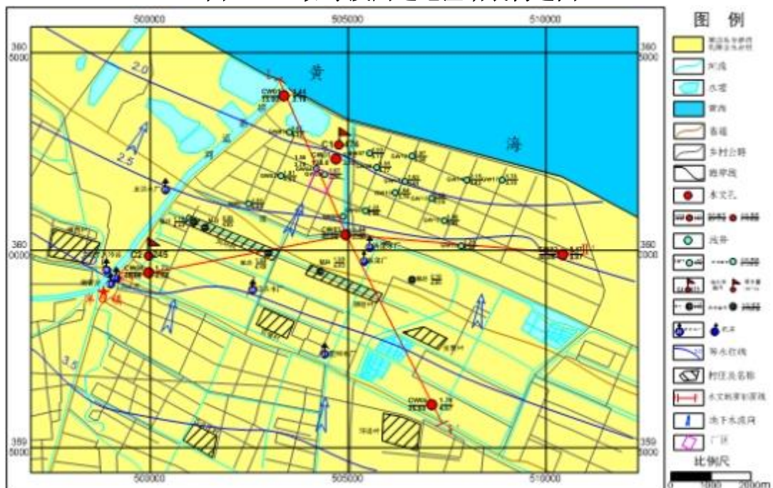
图 5.1-3 如东及周边地区断裂构造图
